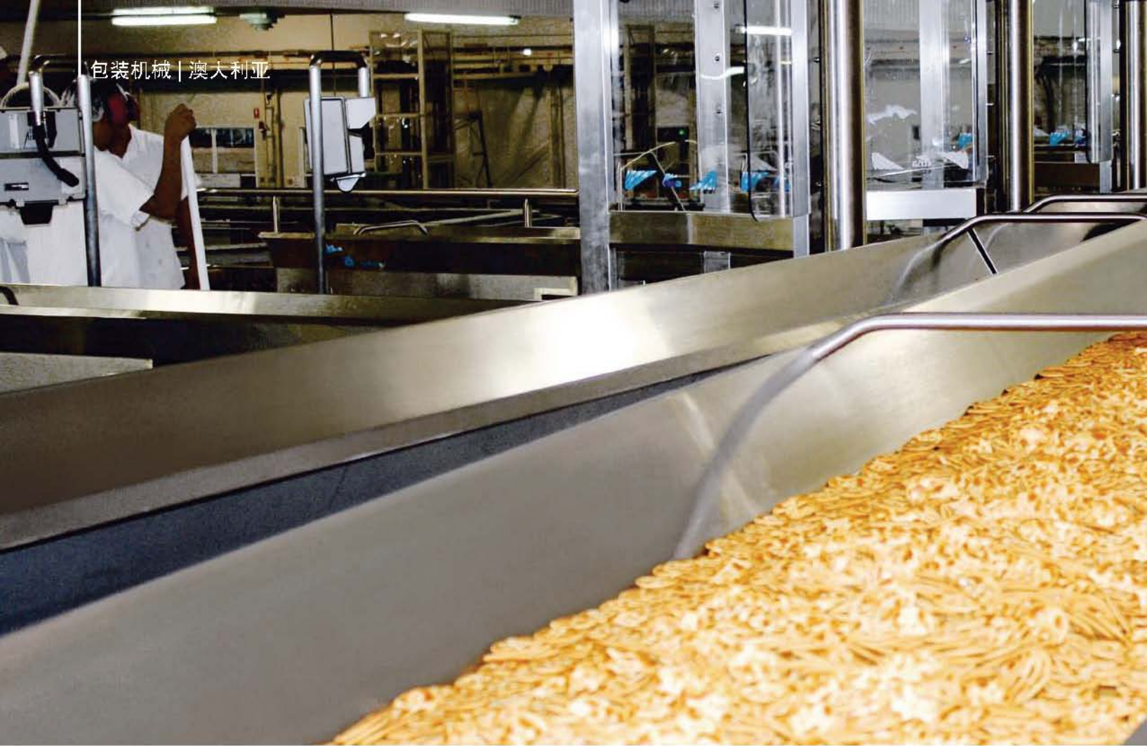
产品在托盘内平稳移动。到达预期位置后，托盘打开卸货。
