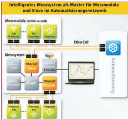
Zentral (schnelle) und dezentral (langsame) gesammelte Messkanäle können Online verrechnet und/oder mit beliebiger Abtastrate der Automatisierung übergeben werden. In einer zweiten Ausprägung werden zwei EtherCAT-Verbindungen eingesetzt.
